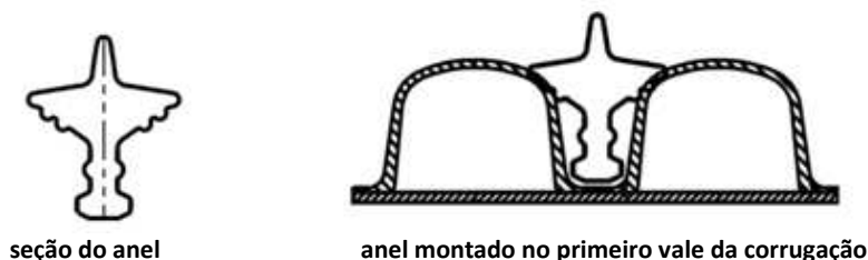
Figura 22 - Anel de Vedação KNTS Super
