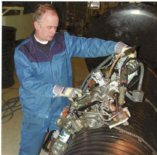
*Figura 31 - Solda por máquina de solda externa*
