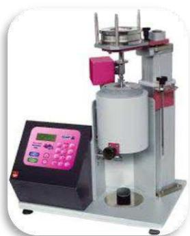
Antes da produção, as matérias-primas são avaliadas quanto ao ensaio de Índice de fluidez e de densidade, para assegurar condições adequadas de processamento e resistência mecânica para o produto.
