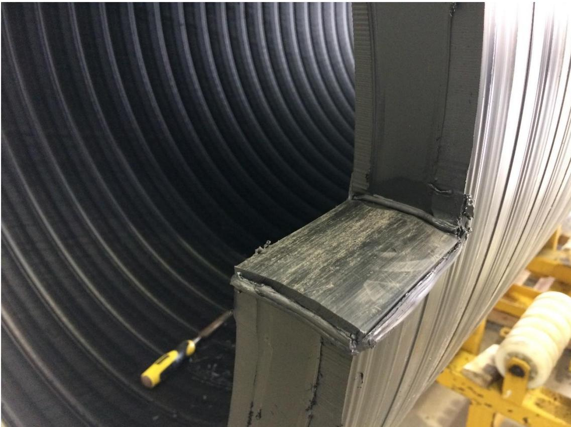
*Figura 32 - A extremidade do tubo KANAWEHOLITE tamponada*
