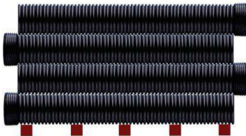
Figura 46 - Acomodação sobre caibros de madeira
