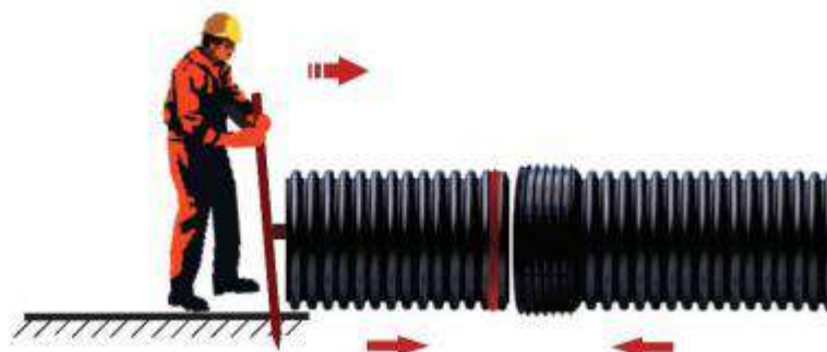
Figura 40 - Introdução da ponta na bolsa
