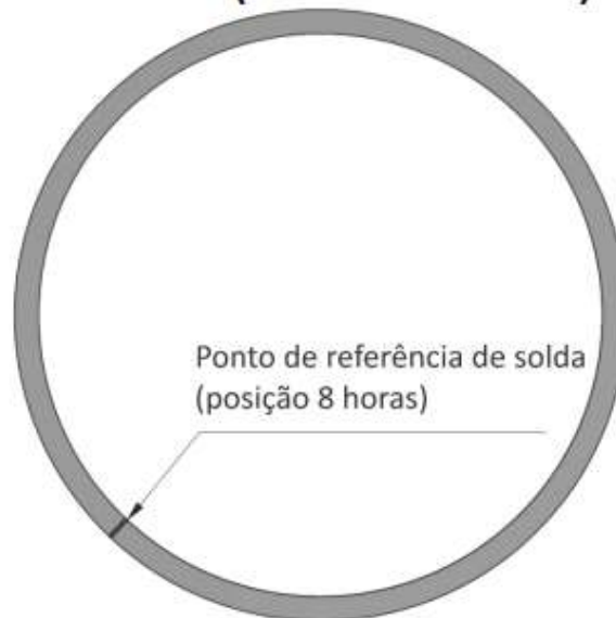
Figura 37 - Direção da solda por dentro do tubo na posição 8h
