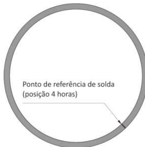
Figura 36 - Direção da solda por dentro do tubo na posição 4h
