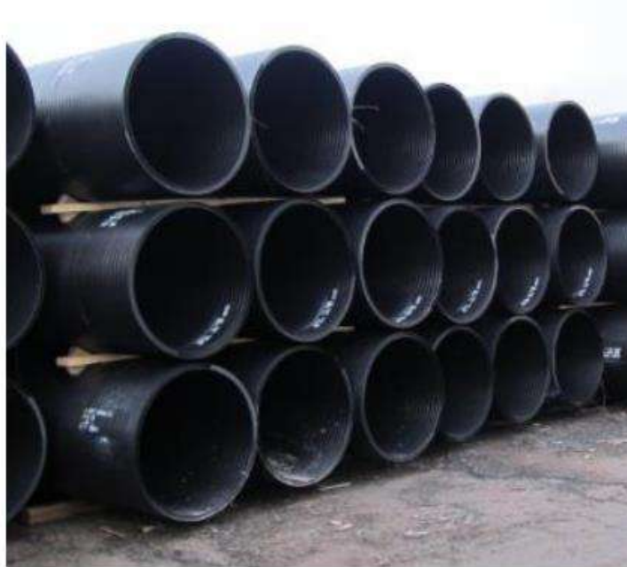
Figura 48 - Acomodação sobre caibros de madeira
