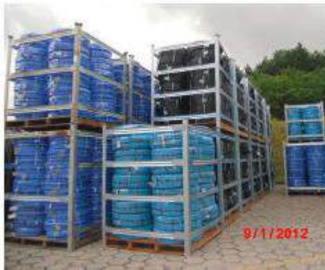
Figura 14 – Armazenamento de Kanalisos DE 20 e 32 mm em rack's desmontáveis.
