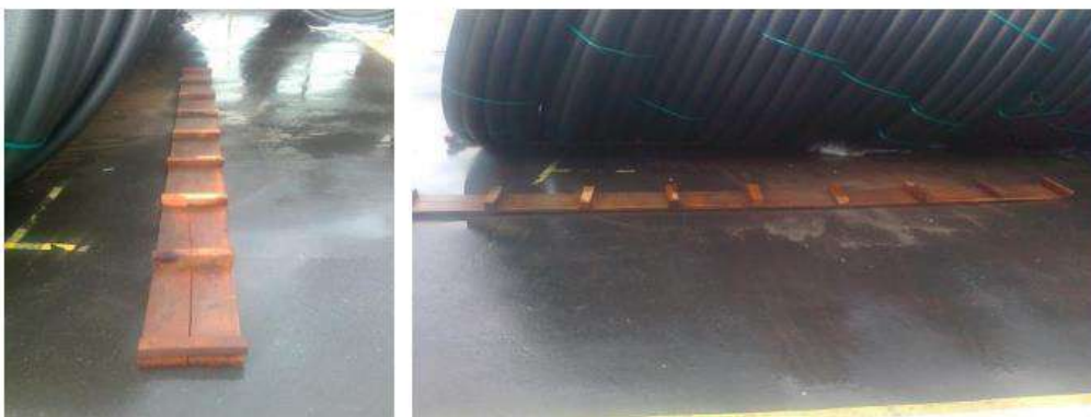
Figura 16 – “Trava-rol” de madeira, que deve ser posicionado abaixo dos rolos.
