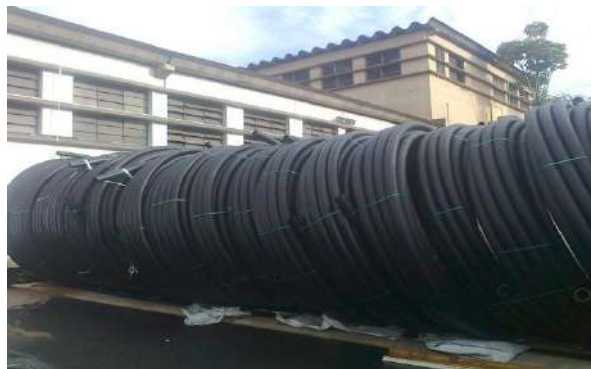
Figura 20 – Armazenamento de Tubos na vertical (para DN 63 à 125).
