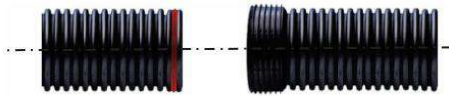
Figura 39 - Alineación de los tubos / Figure 39 - Pipe alignment
