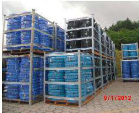
Figura 14 – Almacenamiento de Kanaflex DE 20 y 32 mm en racks desmontables.
