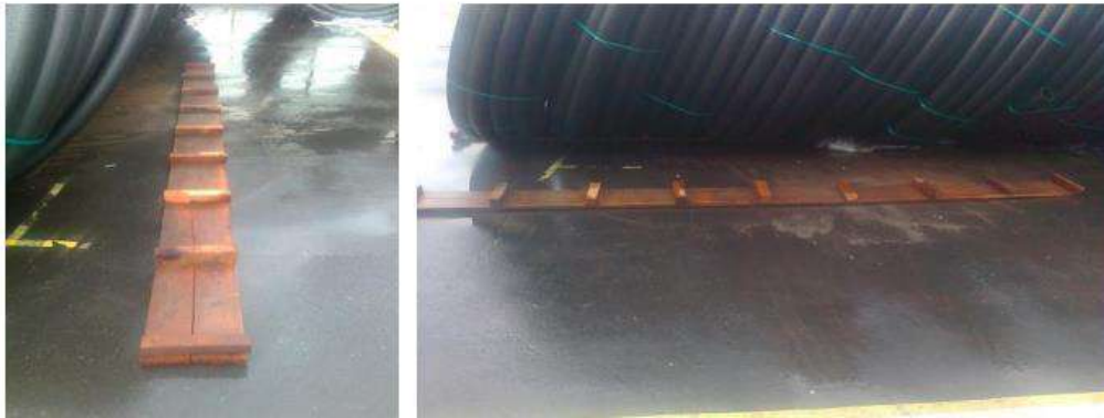
Figura 16 – "Bloqueador de rollos" de madera, que debe colocarse debajo de los rollos.
