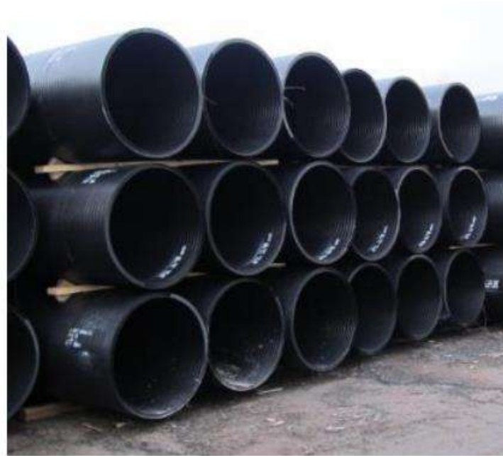
Figura 48 - Acomodación sobre travesaños de madera
