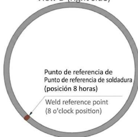
Figura 37 - Dirección de soldadura por el interior del tubo a la posición 8h
