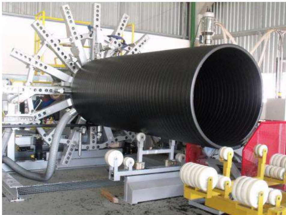
Figura 2 – Tubería KANAWEHOLITE – Fabricación
