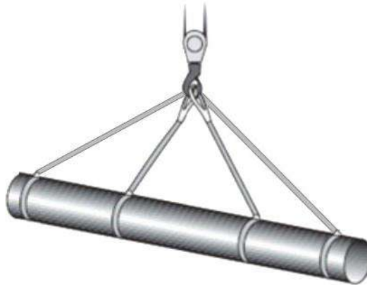
Figura 47 - Descarga y manipulación manual y con eslingas de nylon Figure 47 - Manual unloading and handling with nylon slings
