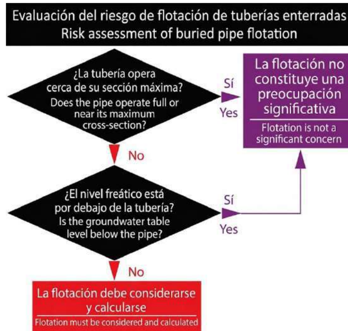
Figura 34: Diagrama de flujo de evaluación del riesgo de flotación para tubo enterrado
