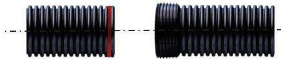
Figura 39 - Alineación de los tubos / Figure 39 - Pipe alignment
